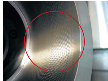
发生了振刀的加工面
