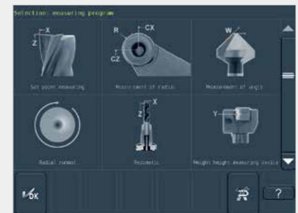
逼真的输入对话框方便选择系统控制的测量程序，如铣头上的最大切削刃及钻头理论交点等。
